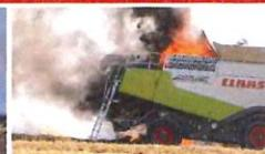
Feu de courroies chauffées sur des roulements coincés
